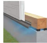
基礎と土台の間に敷き込むことで、自然の気流を利用した床下換気を実現します。また、基礎と土台を絶縁することで湿気が土台に上がることを防ぎます。
